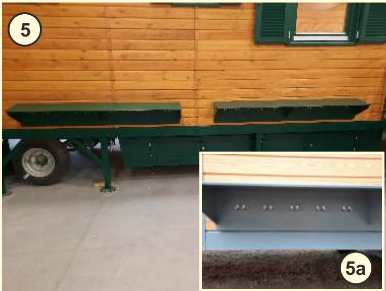
Abbildung 6: Unterbodenstaubbox 400, Maße ca. 290 x 400 x 50 cm (B x L x H), nur für Modell Dagobert.
